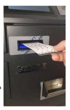
El proceso de limpieza se debe realizar en repetidas ocasiones hasta comprobar que la tarjeta ha capturado la suciedad del billetero y que la tarjeta se ha secado totalmente.
