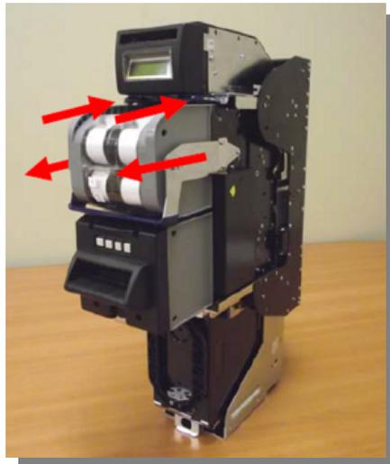
Retire los recicladores y el dispensador presionando el botón de liberación de cada módulo y tirando de él lateralmente para sacarlo del chasis.
